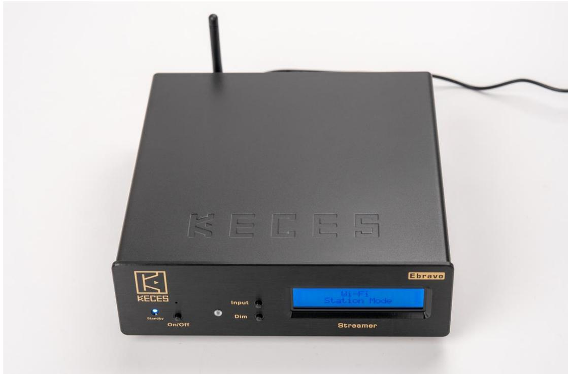
在電路設計部分，**Ebravo** 在網路訊號輸入和數位音訊輸出之間設有電氣隔離措施，並具有獨特的噪訊消除技術，可避免敏感的數位音頻訊號受到網路噪訊的干擾，以提升播放品質。電源方面，**Ebravo** 採用外部直流電輸入，電壓為常見的 12V，DC 電源插孔則是 2.5 / 5.5mm 規格，能兼容市面上大部分的電源供應器，原廠則隨附一顆交換式電源供應器。**KECES** 之所以這樣安排，而不在空間還很充裕的機箱內部設置自家拿手的線性電源，原因不外乎希望使用者多添購一台 **KECES** 的線性電供單機，來提升電源品質。不過這樣的設定其實也有好處，就是使用者可以自行挑選電源，滿足玩電源的樂趣。
